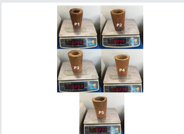
Figura 1: Pesaje de probetas de bambú con 0% de CH, A) 2.01 N, B) 2.40 N, C) 2.48 N, D) 2.70 N, E) 2.66 N.
